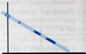
103-сүрөт. Болот шар тоголонуп келип, цилиндрди жылдырат.
